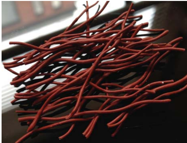
Figura 21. Fibra de acero con revestimiento hidrófugo.
