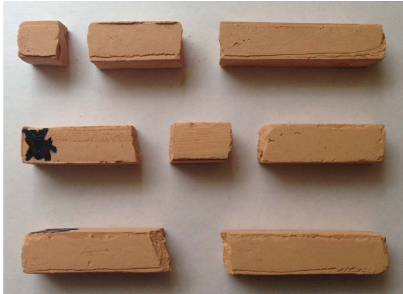
Figura 28. Probetas IZOD sin refuerzo fracturadas.
