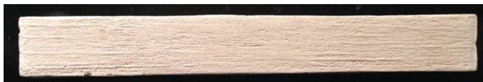
Figura 25. Probeta tipo IZOD de 7.5 cm 3 con 1% de fibra en volumen sinterizadas a 850°C.
