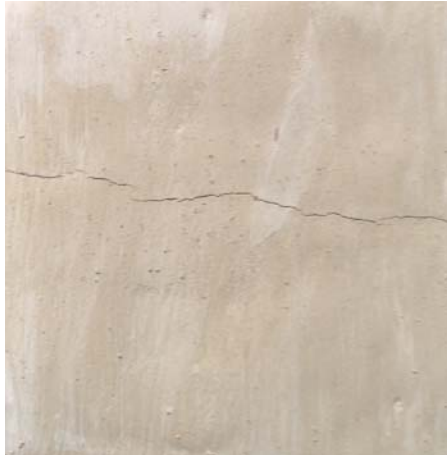
Figura 22. Probeta con refuerzo fracturada durante el secado.
