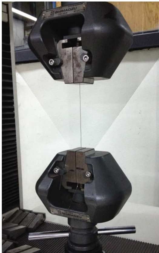
Figura 37. Montaje de las fibras de acero inoxidable en el equipo de ensaye.
