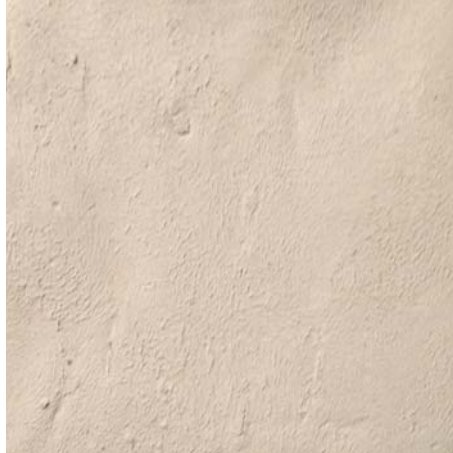
Figura 24. Muestra reforzada sinterizada hasta 400°C sin fisuras observables.
