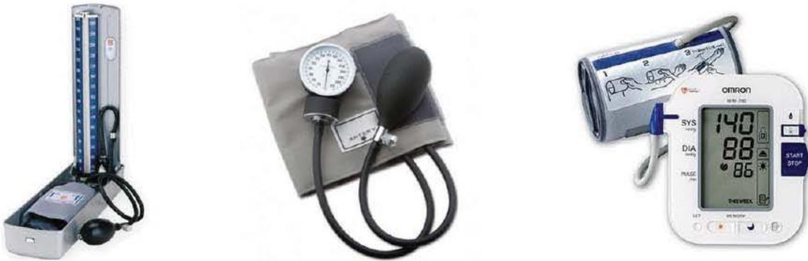
Fig. 18: Esfigmomanómetro de mercurio, aneroides y electrónico (digital).
