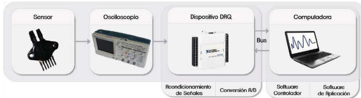
Fig. 36: Elementos del sistema de adquisición de datos.
