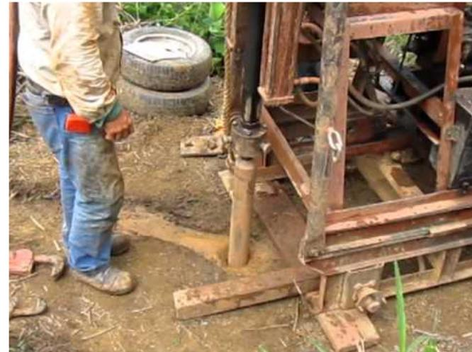
PRUEBA DE RESISTENCIA DEL TERRENO Y MUESTREO
