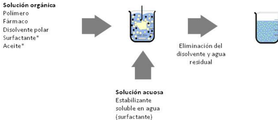
Figura 3. Preparación de NPs por el método de desplazamiento de disolvente [modificado de , Neufeld, Ribeiro y Veiga, 2006].
