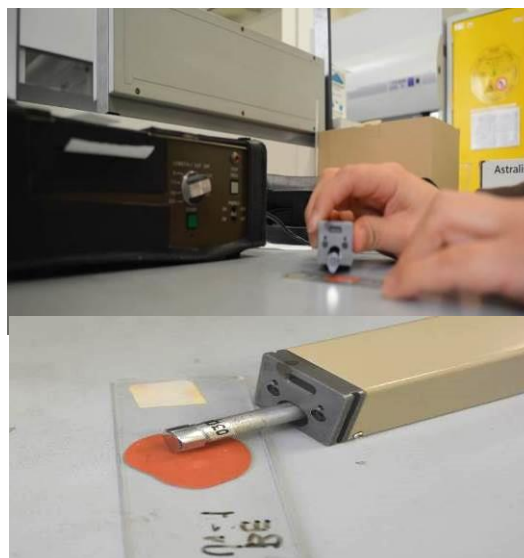
Fig.3.21 . Medición de Rugosidad con Rugosímetro MITUTOYO
