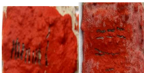
Fig. 3. 35 Aplicación de prueba Pencil Test en muestras PECO sobre mortero
