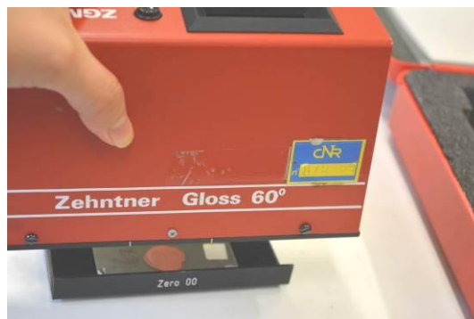
Fig. 3. 15 Medición de Brillo por medio de GLOSS 60° ZEHNETER
