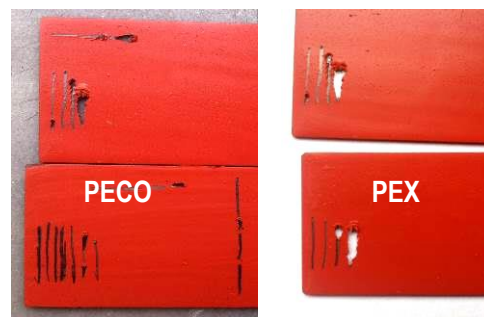
Fig. 3. 34 Aplicación de Pencil test en muestras PEX y PECO sobre vidrio.
