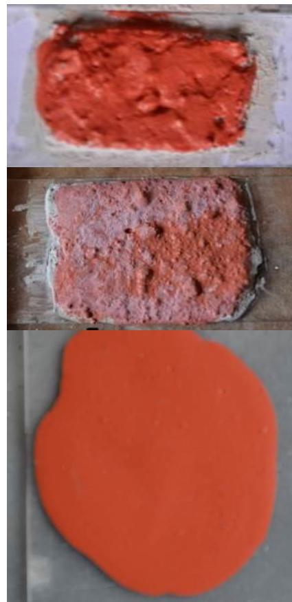
Fig. 3.1 Resultado Cromático Posterior al Envejecimiento Natural
