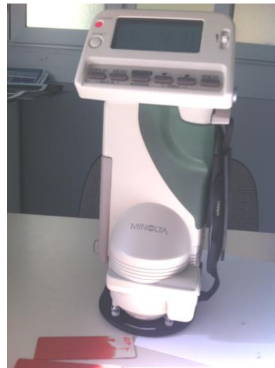
Fig. 3. 2 DELTA E espectrofotómetro MINOLTA CM- 508d
