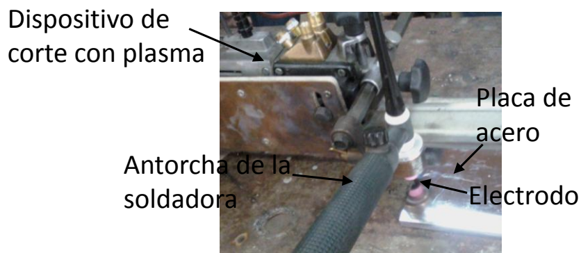
Figura 6. Adaptación de la antorcha de la soldadora al dispositivo de corte con plasma.
