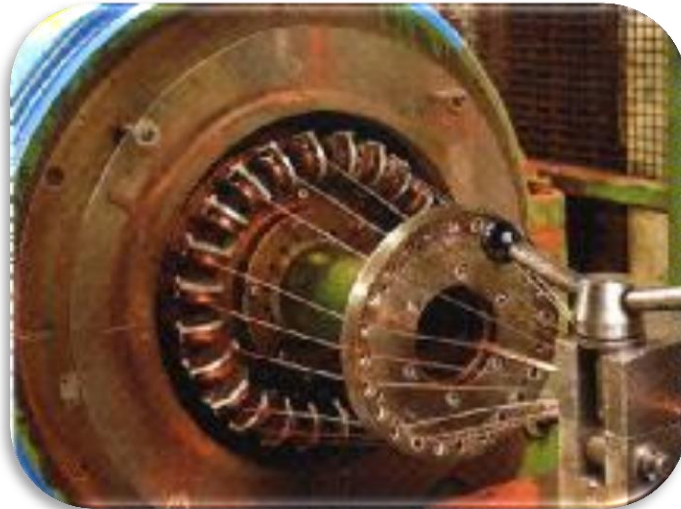
FUENTE: http://www.prysmianclub.es/es/articulo/fabricacion-de-cables-de-cobre FIGURA 2.3 Máquina de trenzado de cables de cobre
