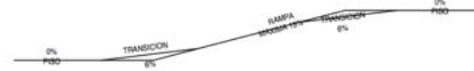
Figura 141 Dibujo de las transiciones de rampas y pendientes máximas, obtenidas del RCDF
