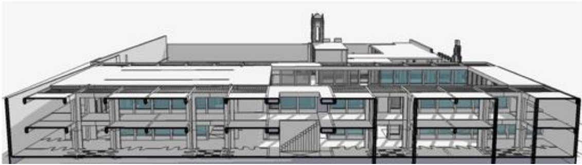
Figura 156 Corte perpendicular a la fachada, nótese la presencia de los patios que articulan las unidades de aulas.
