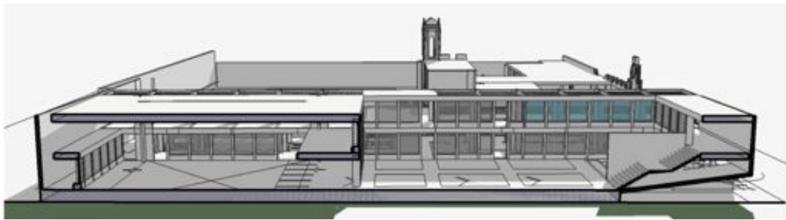
Figura 155 Corte en que se aprecia la transición entre ambos niveles vinculados mediante un pergolado.
