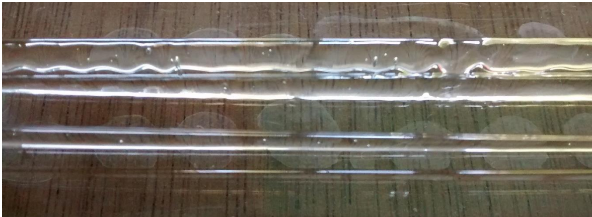
Ilustración 25. Diferentes grosores de hebras impresas que se consiguieron variando las velocidades de desplazamiento y de extrusión.
