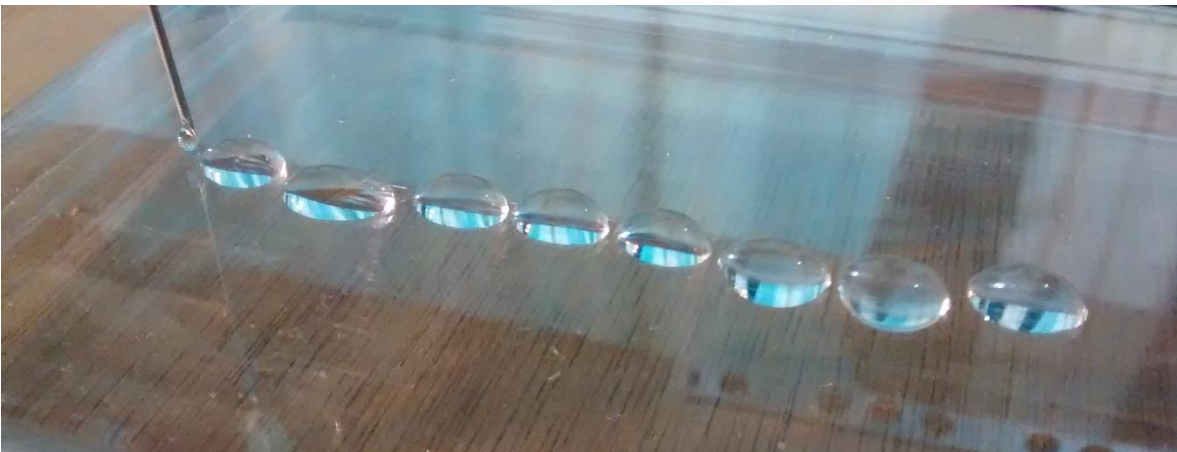
Ilustración 24. Impresión realizada con una jeringa con aguja metálica y fluido no viscoso (agua).
