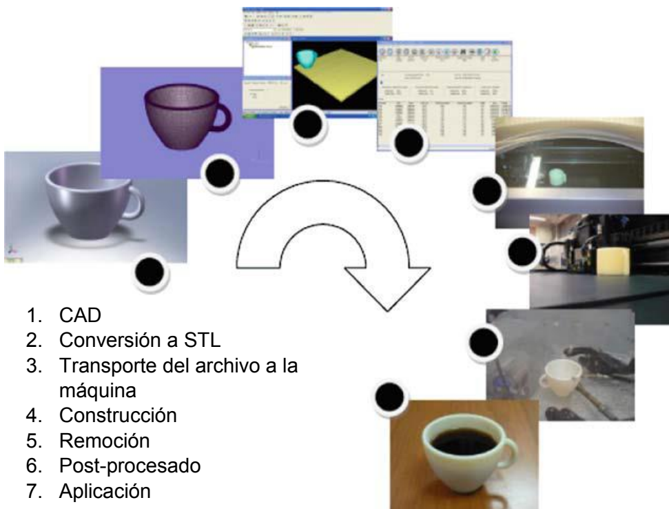
Ilustración 1. Proceso general de impresión 3D.
