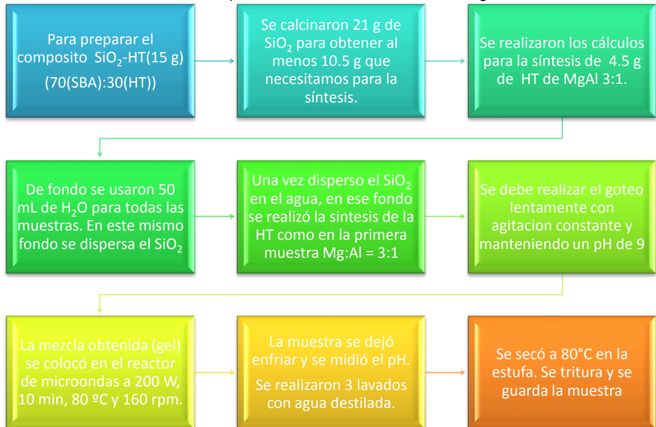
Fig. 10 Proceso de síntesis de SiO_2 -HT
