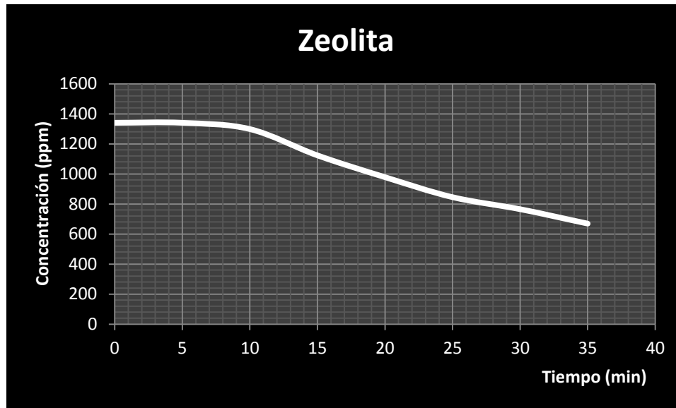
Fig. 31 Curva de retención de cloruros de la zeolita.
