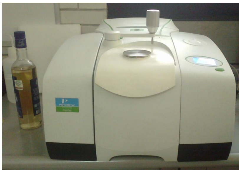
FIGURA 5.1.1.1 Espectrofotómetro Frontier FT-IR MIR Perkin Elmer
