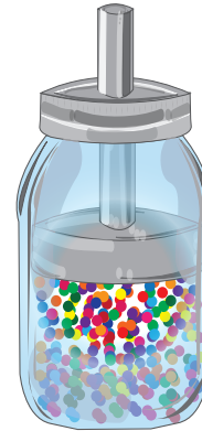
Fig. 1.4 Gas sometido a compresión experimentando aumento de presión. Realizado por el autor.
