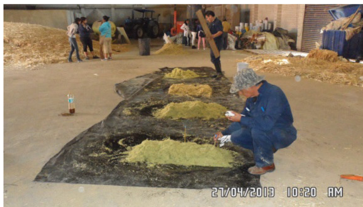
Fig. 4.- Recolección de los valores de las variables respuesta pH y temperatura de la masa fermentativa.
