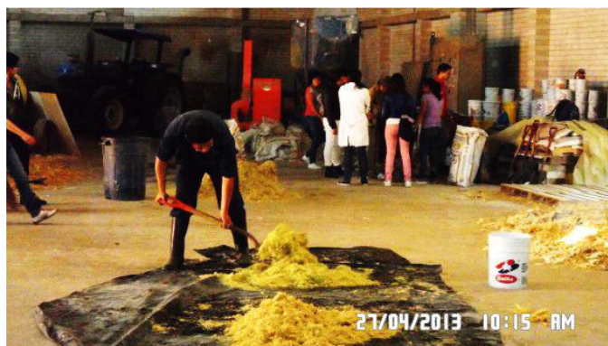
Fig. 3.- Mezclado y volteo del material fermentativo durante el periodo de la elaboración de la SC.
