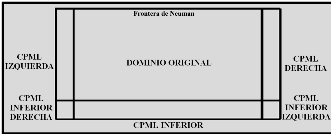
Figura 4.2. Implementación de los subdominio o capas adyacentes CPML en un caso bidimensional.
