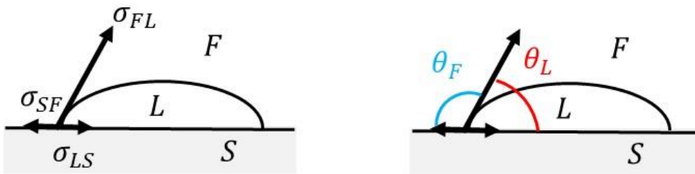
Figura 6.2. Ángulo de contacto en contacto trifásico y equilibrio de fuerzas.
