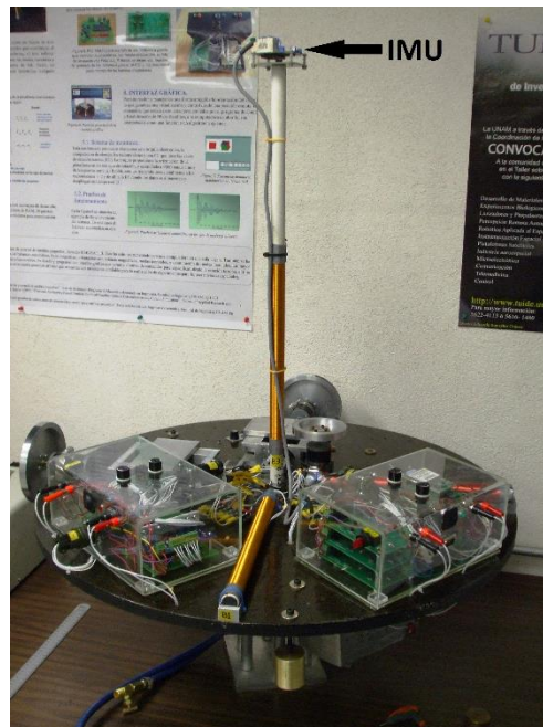
Ilustración 5.27. Plataforma de simulación para el control de orientación de satélites.
