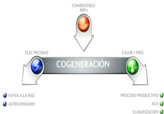
**Ilustración 5.** Sistema de cogeneración.
