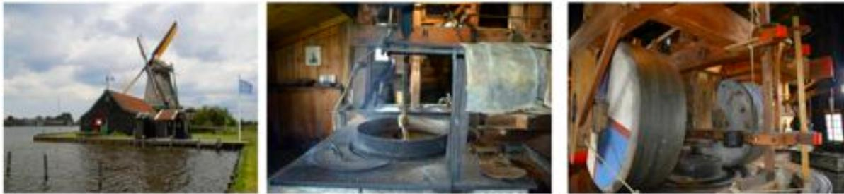
**186. Imágenes actuales del proceso de molido y presión en frío de las semillas del lino al interior de un molino de viento restaurado en Zaanse Schans, Holanda.**
