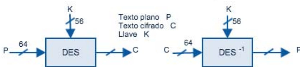
Figura 1.4: DES entrada – salida
