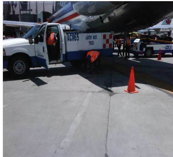
Imagen L Todos los equipos de tierra deben calzarse y colocarse los conos protegiendo el fuselaje del avión.
