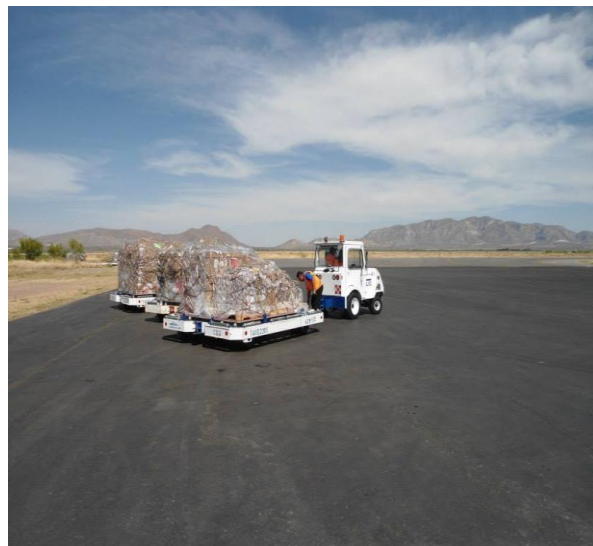
Imagen H A cada tractor se le conectan 4 camas para realizar la carga
