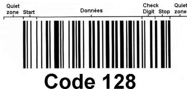
Figura 7 Características de un código de barras. Fuente: http://www.gomaro.ch/Specifications/code128.html
