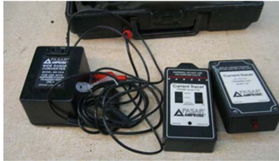
Figura 3-2 Trazador de corriente Amprobe P23
