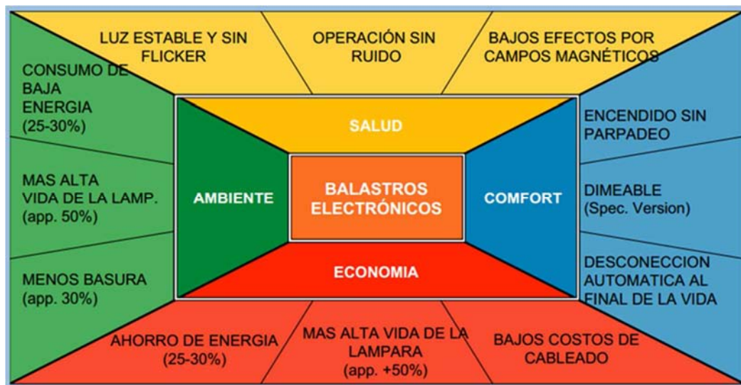
Figura 1-18 Comparación técnico-económica de un balastro electrónico
