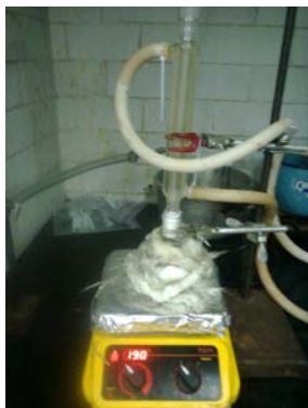
Figura 9-7 Equipo de Reflujo para la obtención del índice de Saponificación.
