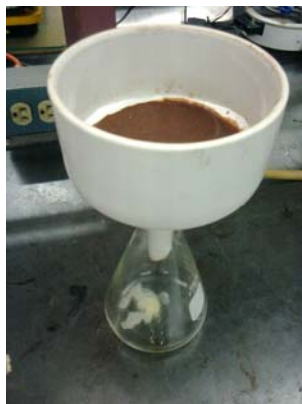
Figura 9-6 Extracción de Manteca de Cacao, Filtrado al Vacío.
