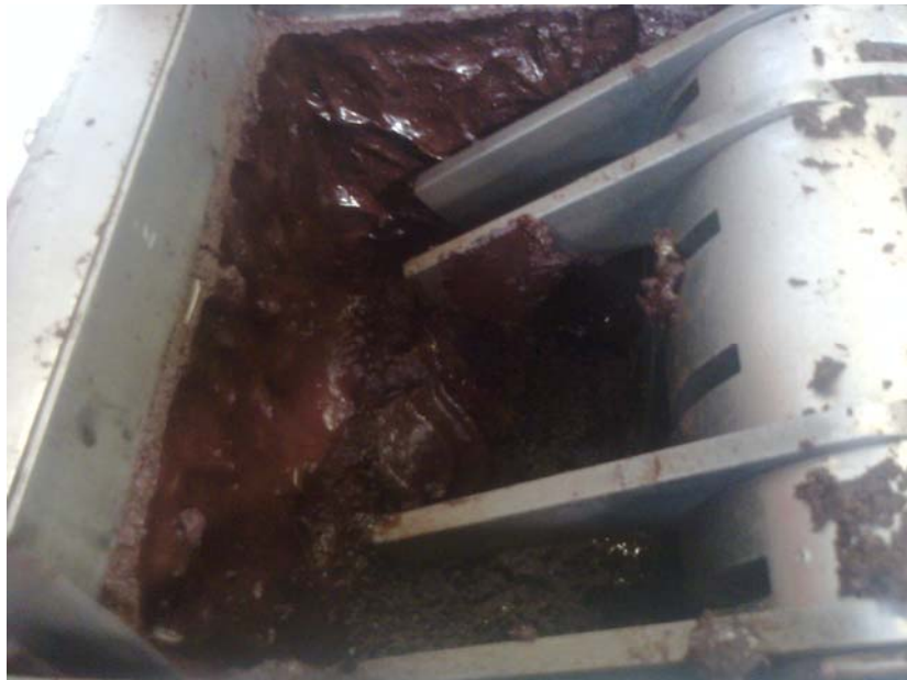
Figura 9-4 Apariencia de la pasta de cacao en la molienda por cuchillas.
