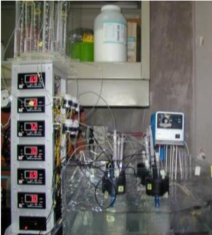
Figura 7. Sistema de Mini-fermentadores o Fleakers
