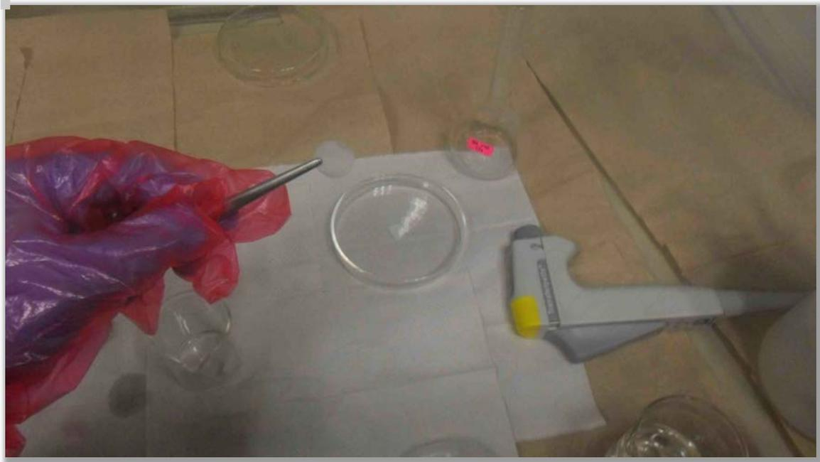
*Imagen 4.4 Impregnado de filtros (Flores, 2012), Físicoquímica Atmosférica, Centro de Ciencias de la Atmósfera.*
