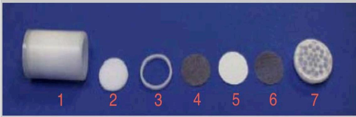
Imagen 4.5 Partes que conforman el captador pasivo (Maria,2004).
