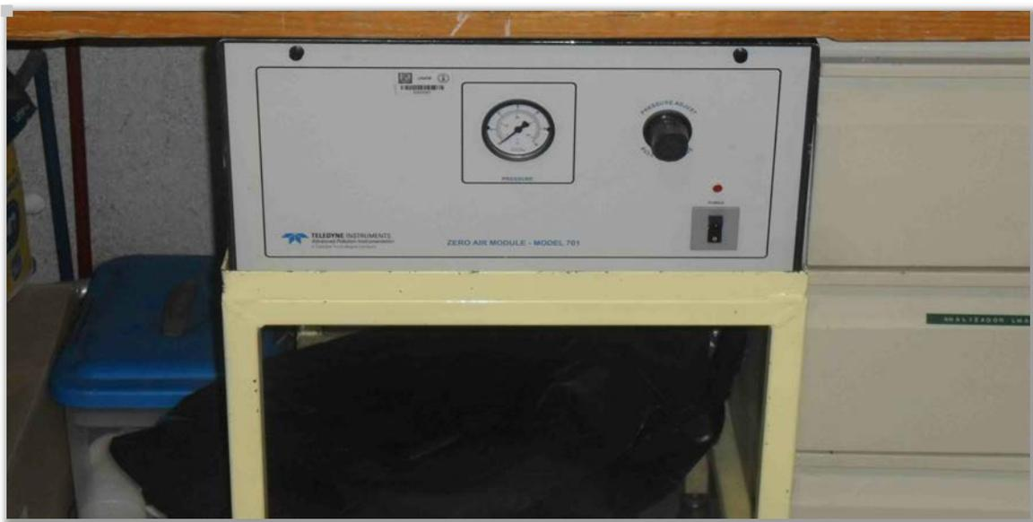
Imagen 4.3 Generador aire cero (Flores, 2012) Físicoquímica atmosférica Centro de Ciencias de la Atmósfera.
