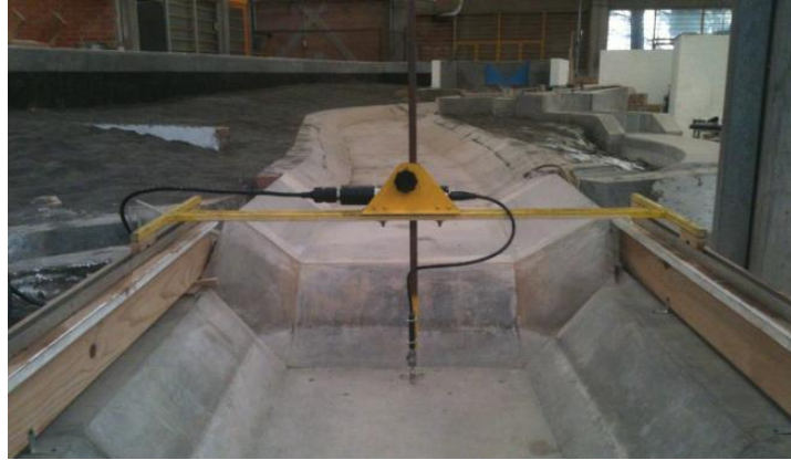
Figura 15 - Esquema de montaje del micro ADV
