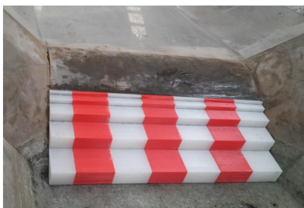
Figura 12 - Ensayo “Rápida escalonada”
