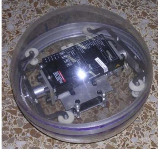
Figura 2.5 Sistema de orientación del robot HIT [22].
