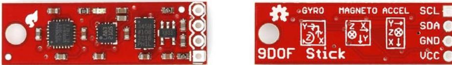
Figura A.17 IMU 9DOF Sensor Stick, versión 13.
