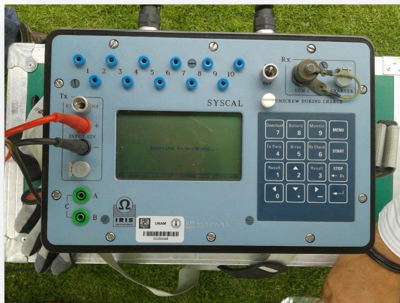
Figura 13. Resistímetro empleado. Syscal
