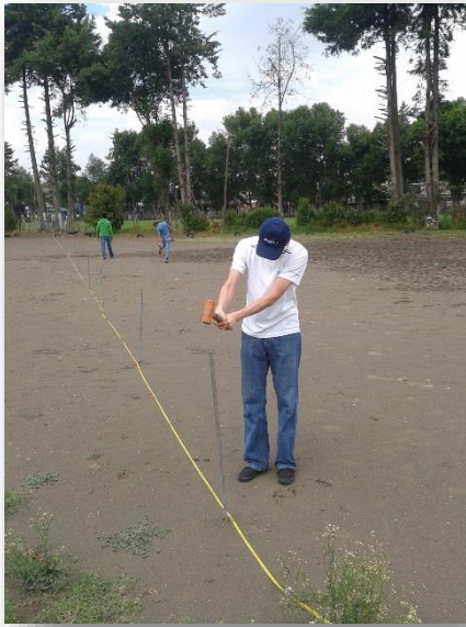
Figura 20. Colocación de los electrodos a cada 4m
