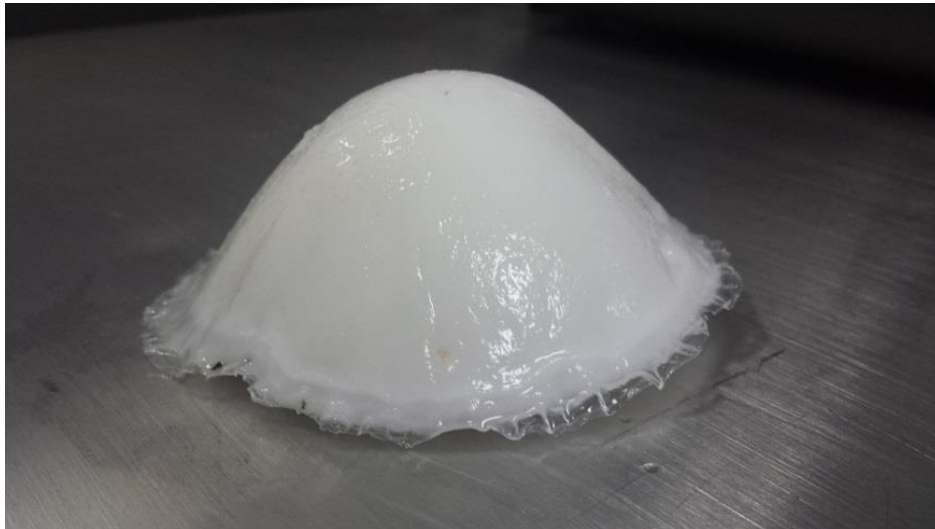
Figura 26 Volumen a base de alcohol polivinílico para simular una mama, que por dentro contiene una uva para simular un tumor.
