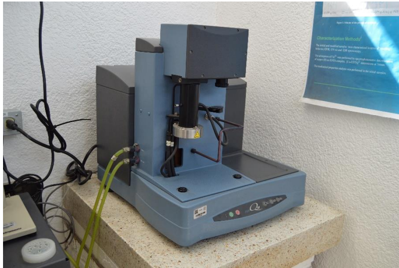
Fig. 11 Equipo para análisis termogravimétrico
