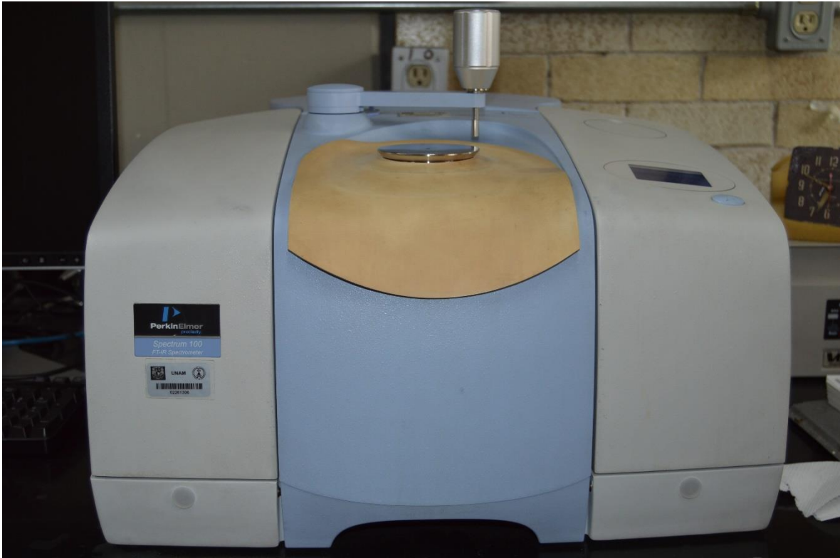
Fig.13 Equipo para espectroscopia de infrarrojo
