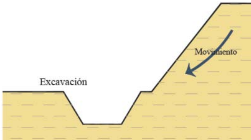
Figura 2.3.6 Excavación en el pie de un talud
