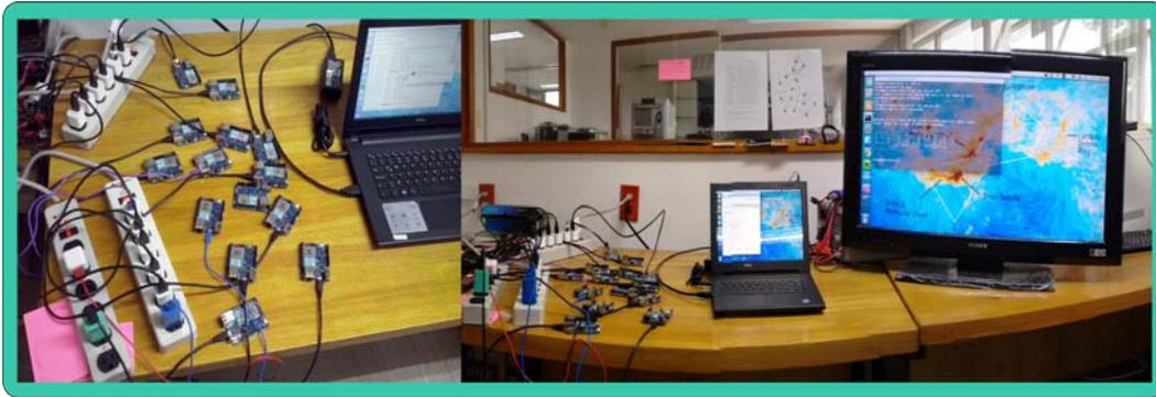
**Figura 5.12:** A la izquierda los 15 Arduino <sup>TM</sup>Yun y a la derecha el esquema completo. La pantalla está conectada a la laptop y de esta se controlan todos los arduinos, via ssh.
