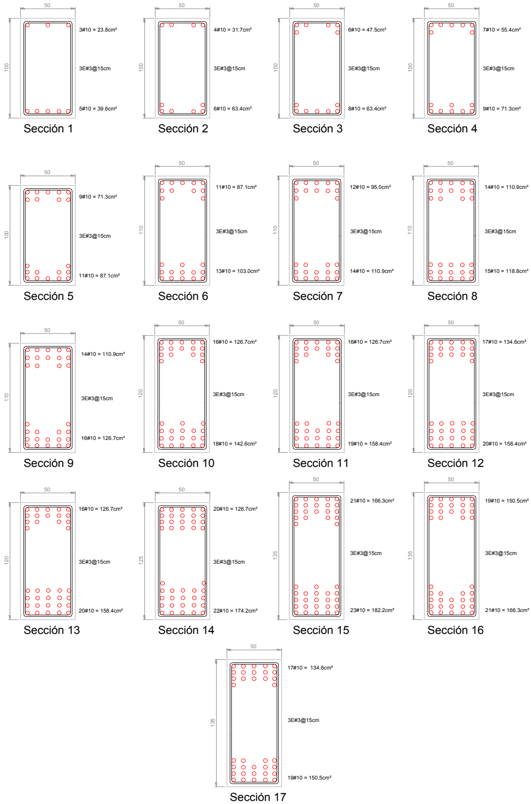
Figura 3.70 Armados longitudinal y transversal propuestos de las vigas del eje C, edificio de 25 niveles, Q= 2, NTC-Sismo del RCDF-P
