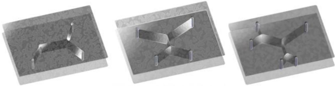
**Figura 14.** Películas que se producen al interior de dos láminas de vidrio unidas por algunos elementos verticales.
