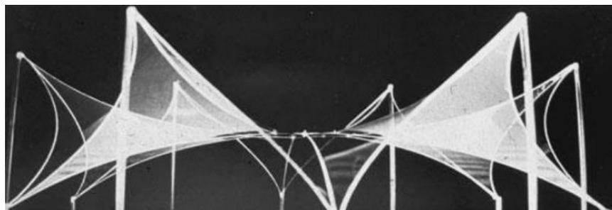
**Figura 6.** Ensayo con modelo a escala realizado por Frei Otto. Películas de jabón sustentadas en sistema de hilos y postes.
