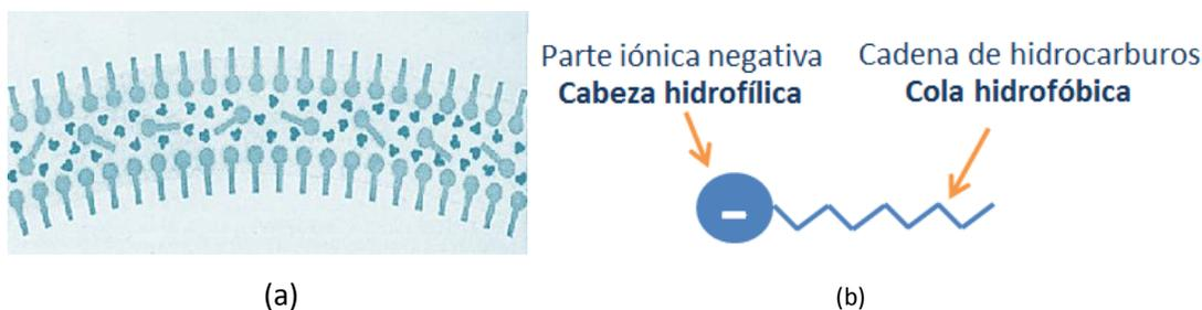
**Figura 19.** (a) Esquema en corte de una burbuja que muestra la capa de agua atrapada entre las cabezas hidrofílicas de las partículas de jabón; y (b) esquema de partícula de jabón.
