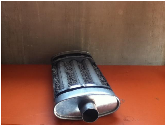
Figura 4.27 Llenado de cámara intermedia con el material adsorbente de CO 2
