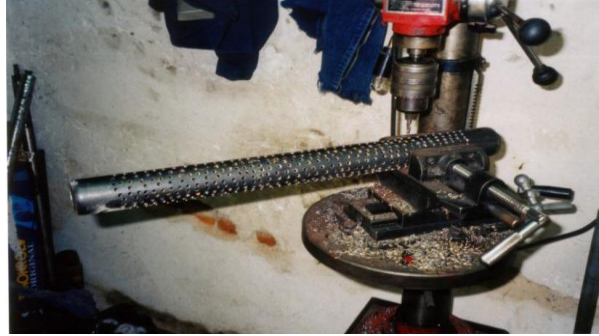
Figura 4.21. Tubo interior terminado de taladrar
