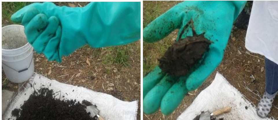
Figura 11. Prueba de humedad por la técnica del puño cerrado.
