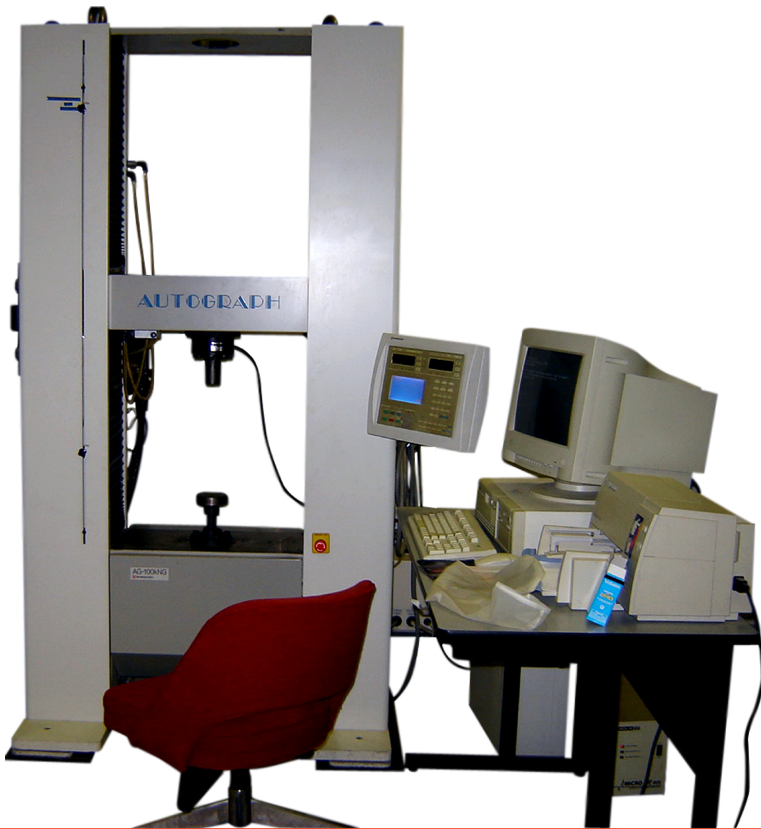
Figura 25. Máquina Shimadzu, Mod. AG-100 KNG. En la que se llevaron a cabo las pruebas de Compresión y Flexión en Tres Puntos, la cual se encuentra en el Instituto de Física, Laboratorio de Cristalofísica y Materiales Naturales.
