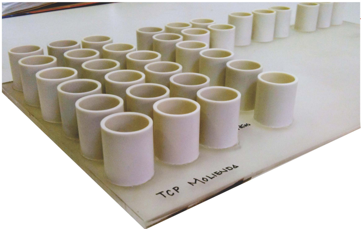
Figura 14. Elaboración de moldes y vaciado posteriormente con mezclas de Cemento Portland y Cementos con Aditivos
