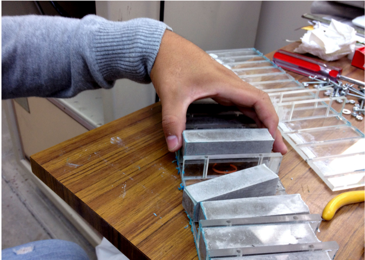
Figura 17. Desmolde de las probetas de Cemento Básico y Cemento con Aditivos.
