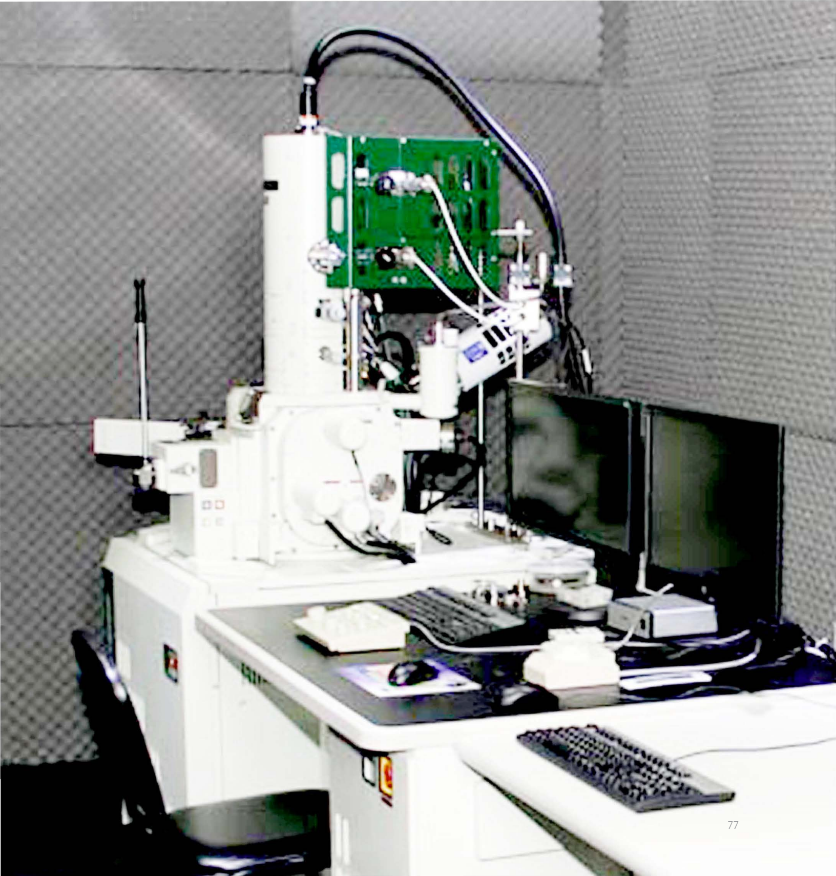
Figura 26. Microscopio de Barrido JEOL, en sesión de micrografías para cemento
