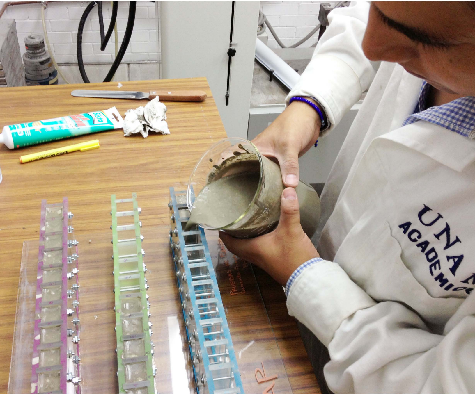
Figura 17. Se pueden ver los moldes fabricados en acrílico, el proceso de vaciado y el proceso de desmontado respectivamente. La dimensión de las probetas se muestra en la figura 18.
