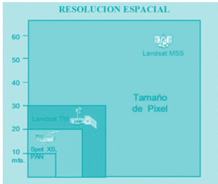
Figura 15. Diagrama que muestra el tamaño de pixel de imágenes pancromáticas y multispectrales de los satélites SPOT Y LANDSAT.(Inegi, 2015).
