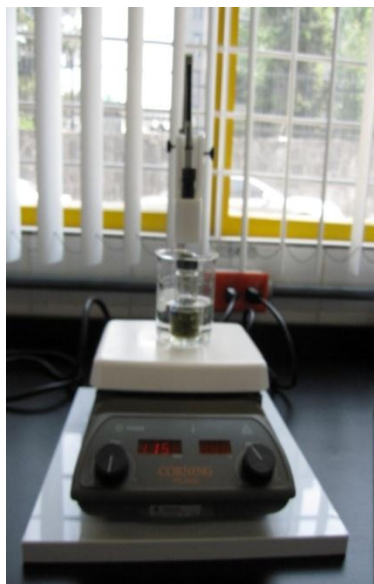
Figura 5. Microextracción en fase solida por el método de espacio de cabeza.
