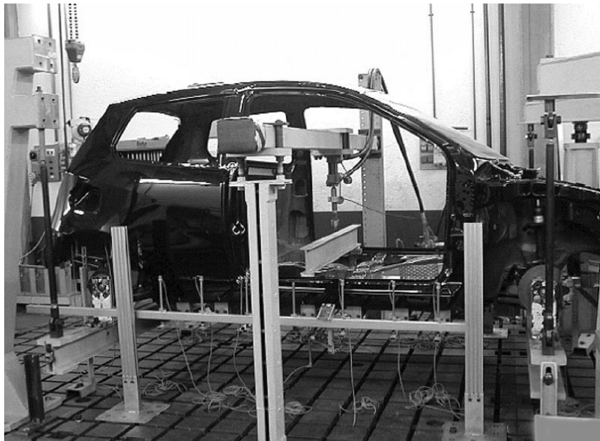
Figura 1.8. Banco de pruebas de flexión [12]
