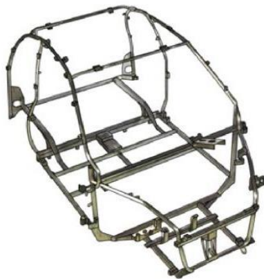
Figura 1.4. Chasis tubular de cuadríciclo [24]
