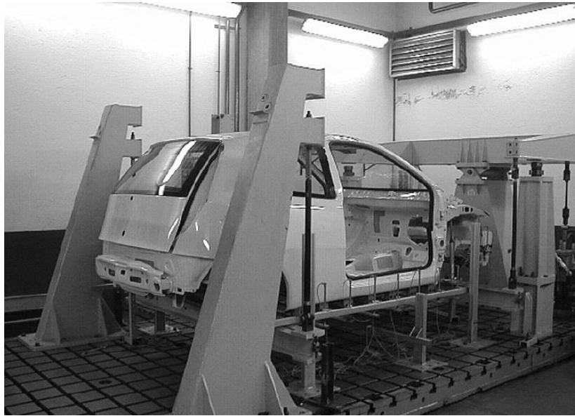
Figura 1.7. Banco de pruebas de torsión [12]
