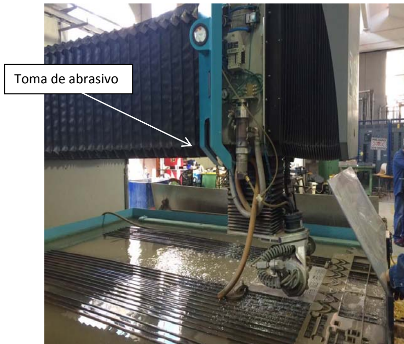
Figura 3.11 Toma de abrasivo para generar corte en la WJC (Cortadora ubicada en CCADET)
