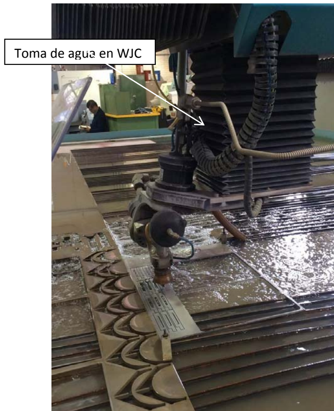
Figura 3.9 Toma de agua para generar corte en la WJC (Cortadora ubicada en CCADET)
