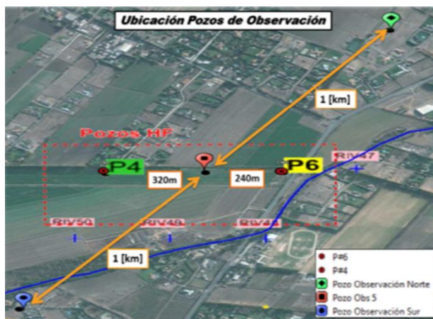
Figura 2.4. Ubicación de los pozos de infiltración P4 y P6, cerca de ellos los pozos de observación Norte (a 1 km aguas arriba), Sur (a 1 km aguas abajo) y Obs 5 (justo en medio de P4 y P6).
