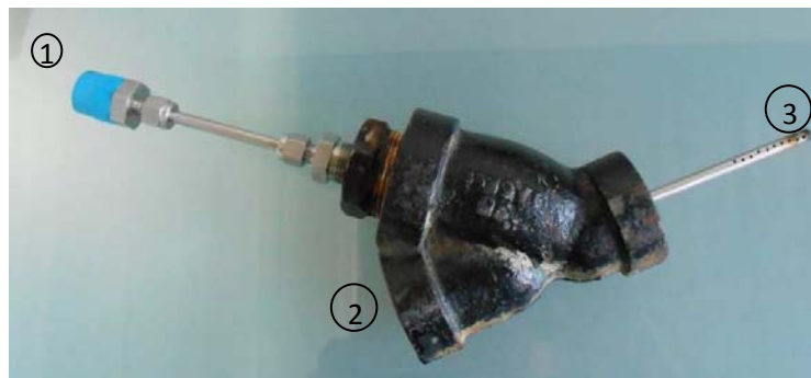
Figura. 4.10. Mezclador de vapor de amoniaco con solución amoniaco-agua.
