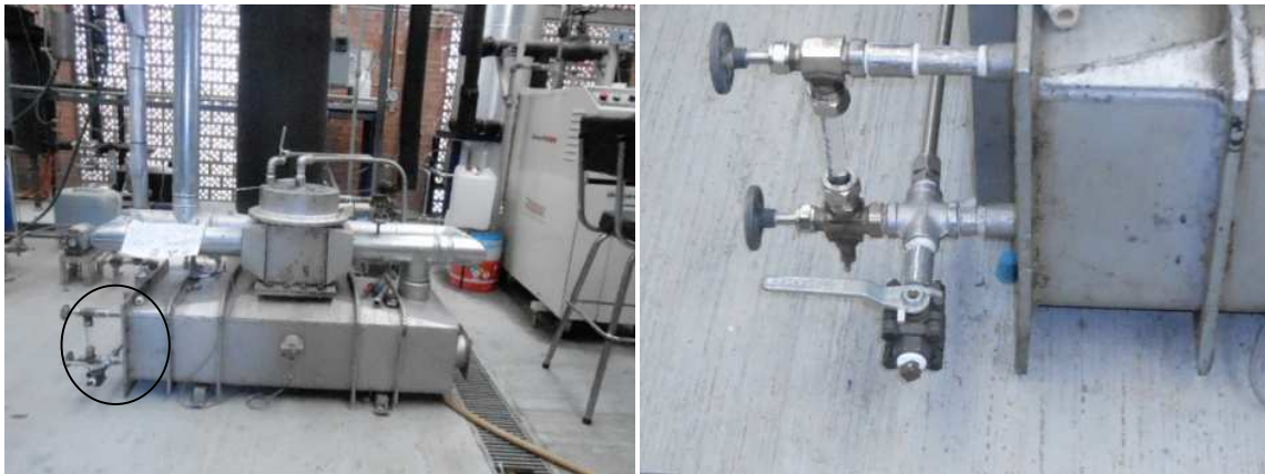
Figura 4.8. Carga de la mezcla amoníaco-agua en el GFD.
