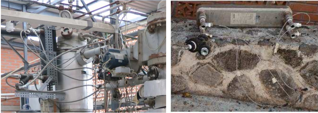
Figura 4.9 a) intercambiador de calor de placas acoplado a la columna AB-GAX y b) vista del equipo de forma individual.
