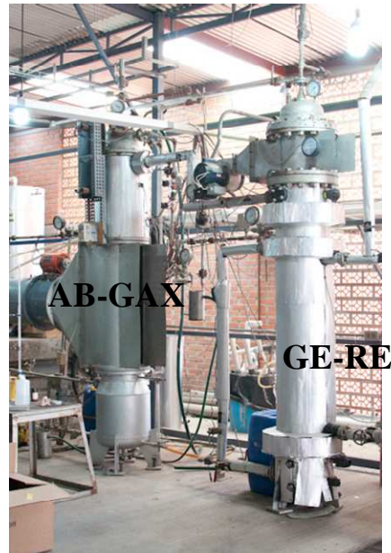
Figura 2.1 Prototipo del sistema de refrigeración por absorción avanzado GAX del CIE-UNAM donde se observa la columna del generador-rectificador y la columna absorbedor GAX.
