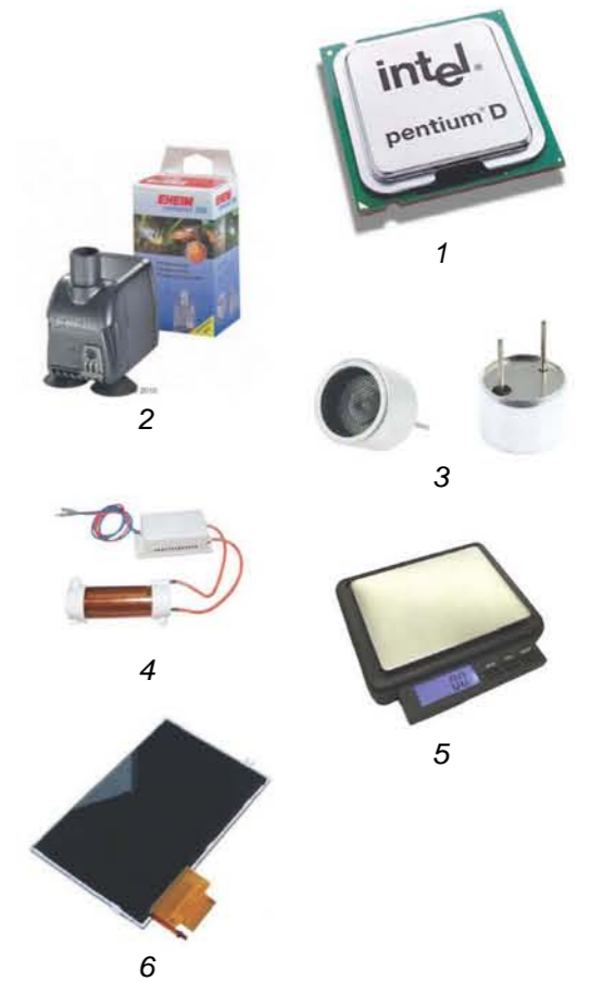
1. Microprocesador 2. Bomba de agua 3. Transductores 4. Generador de ozono 5. Balanza de precisión 6. Pantalla de cristal líquido.
