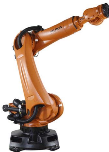
Figura 1.1 Robot Manipulador Antropomórfico
