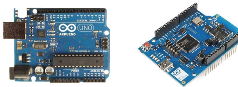
Figura 3.5 Micro-controlador ARDUINO y módulo de comunicación Wifi
