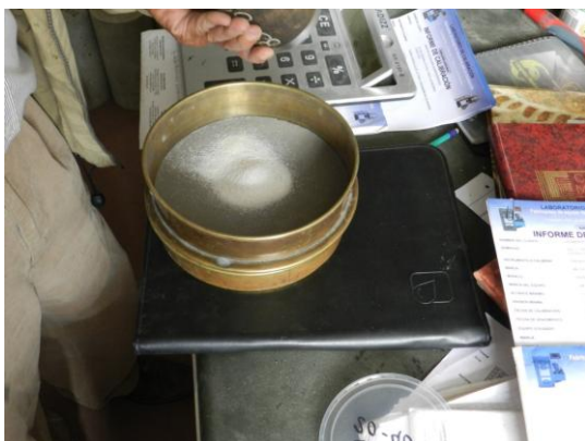
Fotografía 13. Vaciado de cilindro (der), cribado de muestra para conocer cantidad de finos producidos posteriormente (der).
