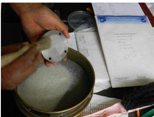
Fotografía 13. Vaciado de cilindro (der), cribado de muestra para conocer cantidad de finos producidos posteriormente (der).
