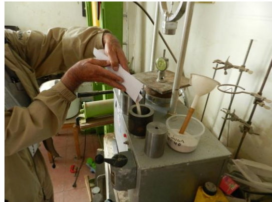
Fotografía 11. Pesado de muestra (izq) y vaciado en el cilindro para prueba de resistencia a la compresión (der).
