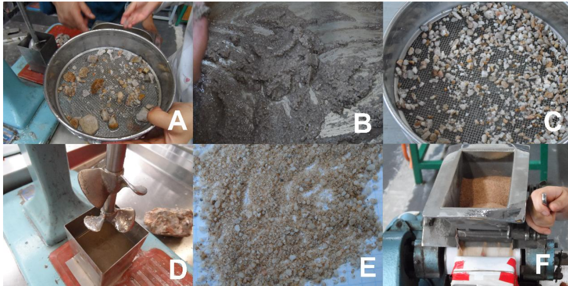
Fotografía 18. A) Muestras usadas (combinadas), B) Después del proceso de molienda, C) Separación y clasificación, D) Uso de atricionador para separar los clastos restantes, E) resultados, F) por último, separador magnético.
