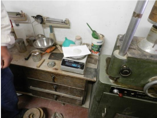
Fotografía 11. Pesado de muestra (izq) y vaciado en el cilindro para prueba de resistencia a la compresión (der).
