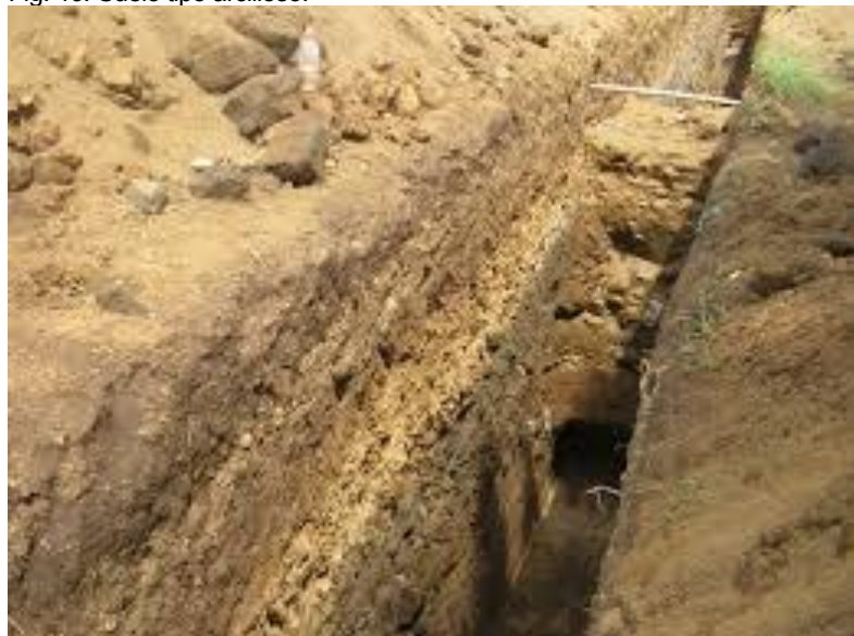
Fig. 46. Suelo tipo arcilloso.
