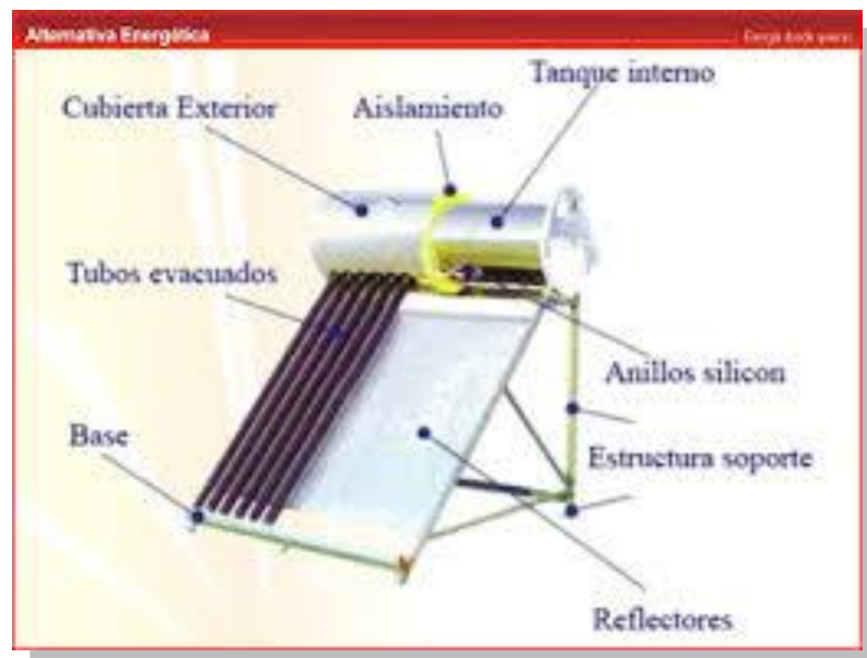
Fig.133 . Esquema de un calentador solar.
