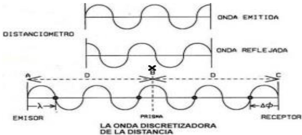
**Fig.2.10 Diagrama de la medición electrónica de distancias**
