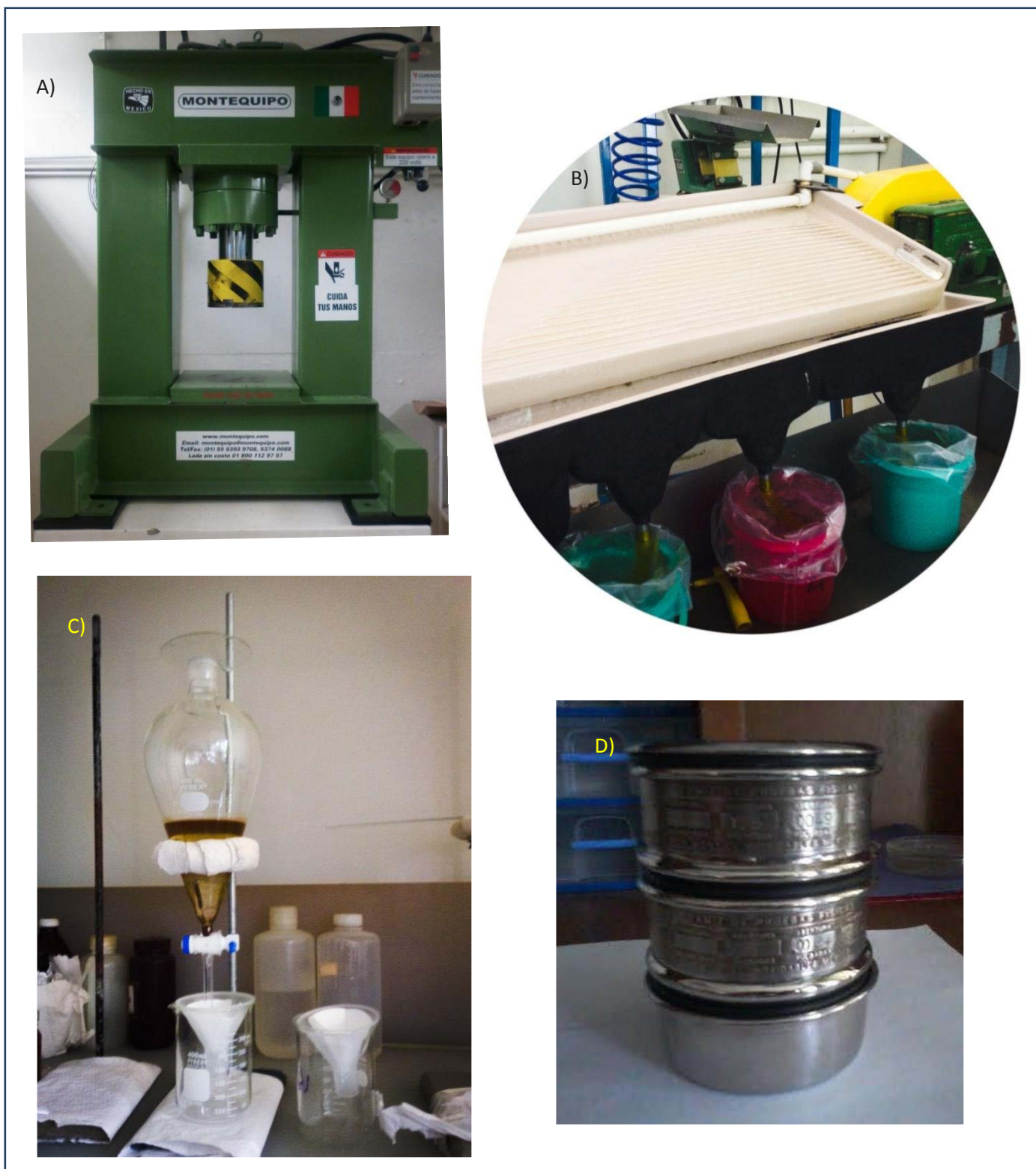
FIGURA 4.3 A) PRENSA HIDRÁULICA DEL TALLER DE MOLIEDA DEL INSTITUTO DE GEOLOGÍA DE LA UNAM; B) MESA WILFLEY; C) EMBUDO CON BROMOFORMO Y VASO DE PRECIPITADOS CON FILTRO PARA RECIBIR LOS MINERALES DECANTADOS Y D) TAMICES CON MALLAS DE 0.124 Y 0.062 MM.
