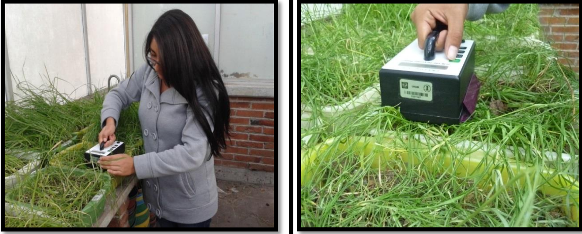
Figura 16. Medición del NDVI mediante el sensor Field Scout TCM 500.
