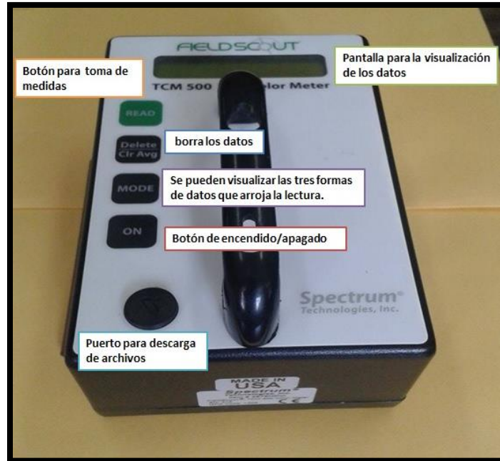
Figura 5. Partes del sensor.
