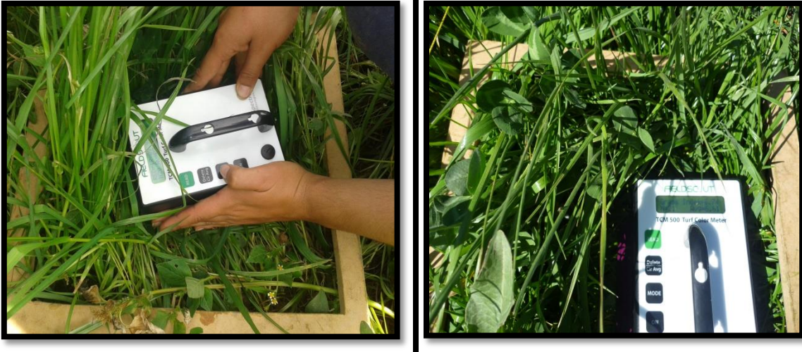
Figura 22 . Medición del NDVI mediante el sensor Field Scout TCM 500
